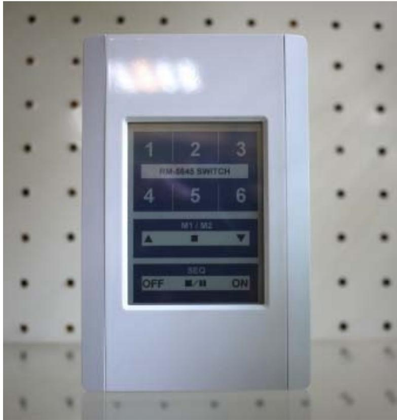
C-P112F 牆壁觸控面板，保有原 P112 外觀精巧使用簡單，採標準 4 線電阻式觸控面板矩陣式按鍵，更升級擴充支援連結雙繼電器模組 (RL-M105) 可直接控制強電功能
