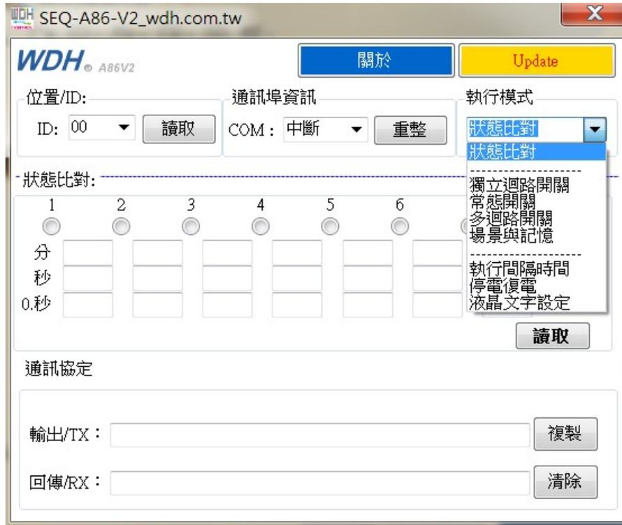
以往隨機內建搭載眾多精細綿密的通訊協定，並無法為外界充分解讀應用，本公司有鑑於此特研發一系列產品專用軟體，利用軟體將機器內的通訊協定，以最簡單易懂的方式做最完整的呈現，8 個輸出迴路，各輸出迴路之間的時間設定，迴路開啟/關閉順序，緊急斷電復電處置或原本位於頂層的液晶歡迎進階顯示畫面，皆允許使用者透過本軟體設定，簡學易懂現學活用，化繁為簡向來是本公司最大努力目標！
